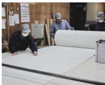
硬質フェルトの検反工程。検反機と人の目により、1反1反丁寧に品質を確認して完成する。
