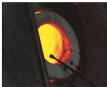
ツボの中で真っ赤に溶けた硝子は、約1400℃になる。
