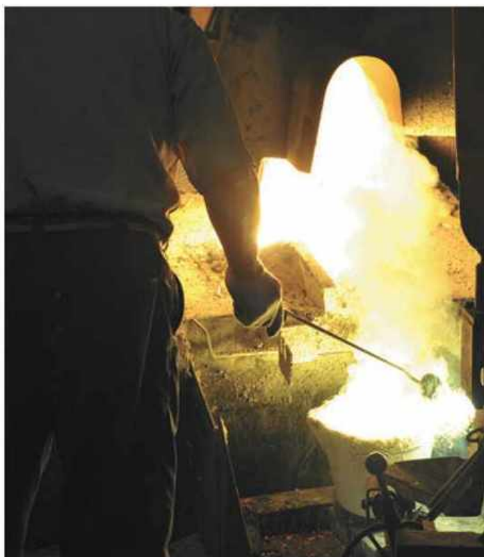
真鍮を溶解する温度は1000℃を超える。 職人は想像を絶する猛烈な暑さと戦いながら作業を行なう。
