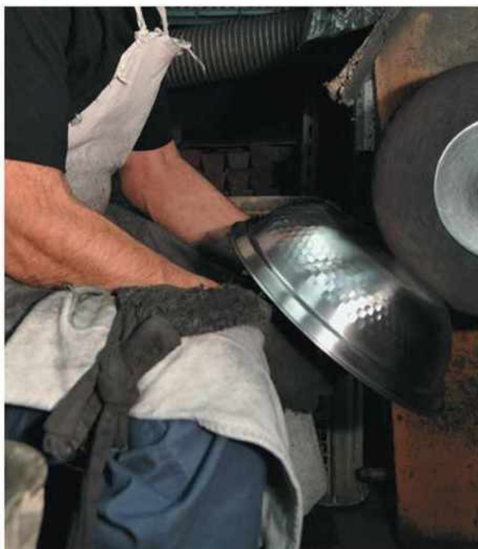
成型した後は、シャフトに羽布をセットして高速回転で磨きを掛ける。
