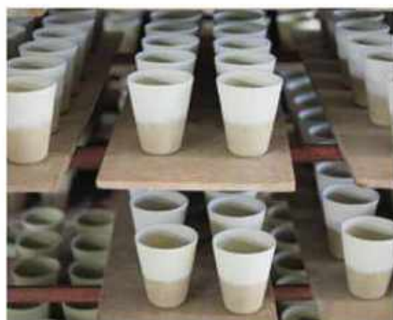
化粧掛けの後、生地の水分がなくなるまでしっかり乾かす。その後、素焼、施釉、本焼の工程へと進む。
