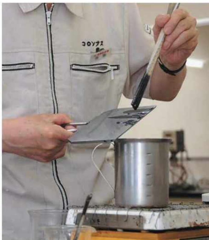
数段階の温度に分けて、固まり具合、粒子の細かさ、伸び具合などを詳細にチェックする。
