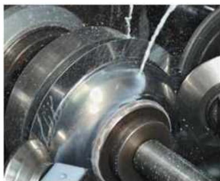
熱による金属疲労が起らないよう、水溶性の油で冷却しながら金属を伸ばしていく。
