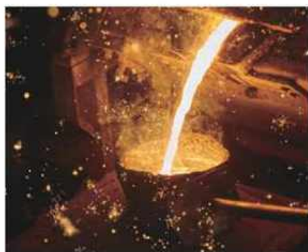
湯（溶けた金属）を型に流す注湯作業。今ではきれいな型を作る職人もだんだんと減ってきているという。
