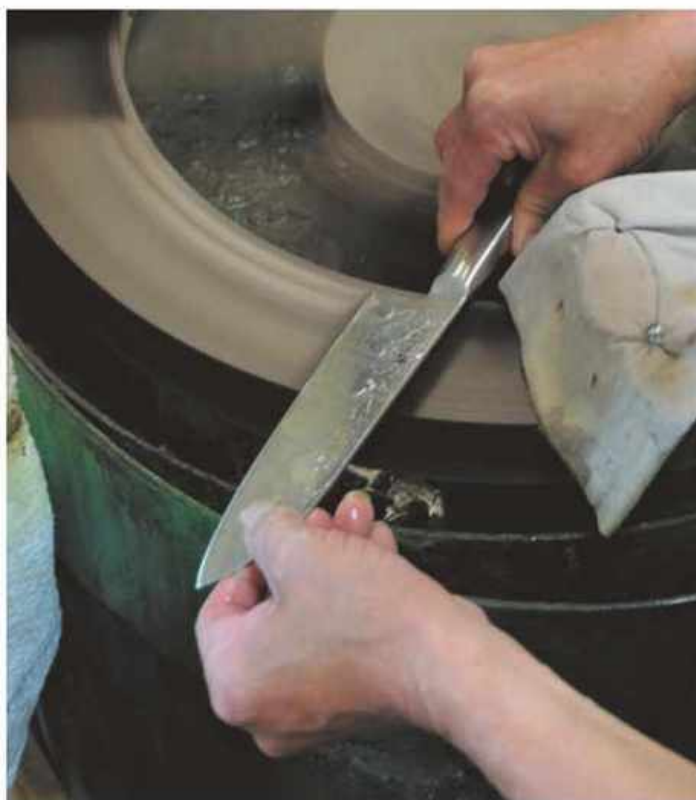
この道20年の職人による刃付け。神経を研ぎ澄まし、数ミリ単位で削る。
