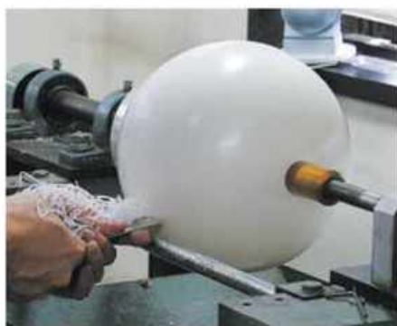
ベースはプラスチックの白球。2つの半球を接着して球体に成形したら、バリ取りなどを施して均等な球体に整える。
