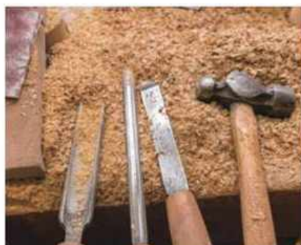
ろくろ挽きで使用するバイトと呼ばれる刃物。3本を使い分けて成形する。
