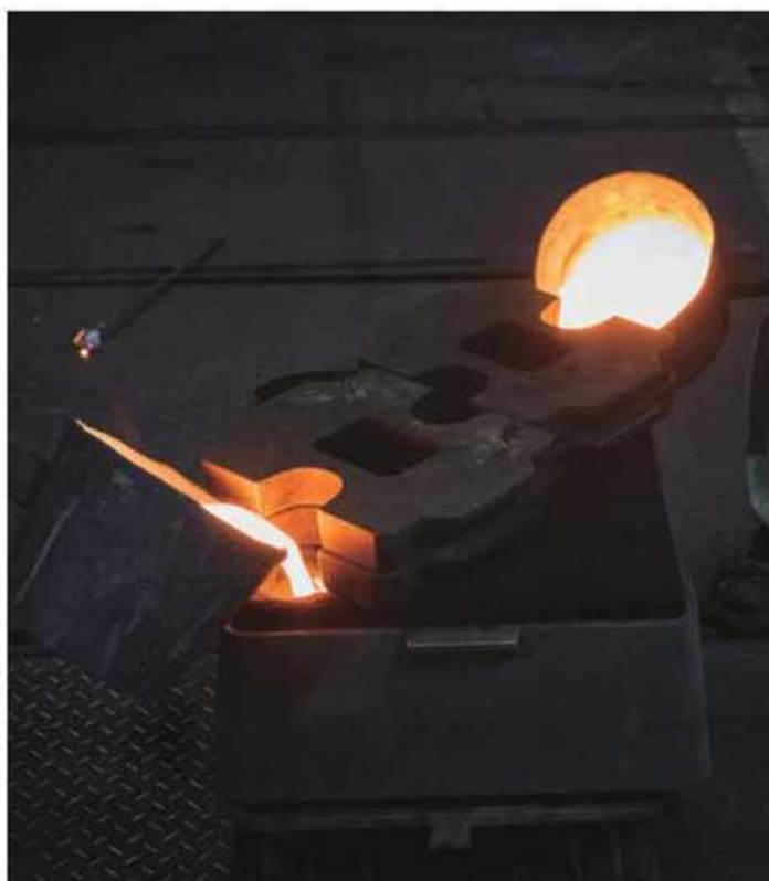
「注湯」の工程は職人が2人がかりで行う。溶鉄の温度は約1500℃。危険を伴いながら、慎重かつ素早く注がれる。
