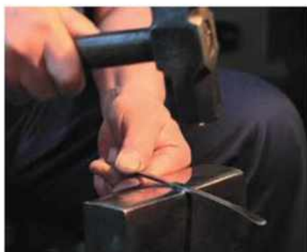
両端と両面から金鎚で叩くことで、均等の薄さにする技は見事。
