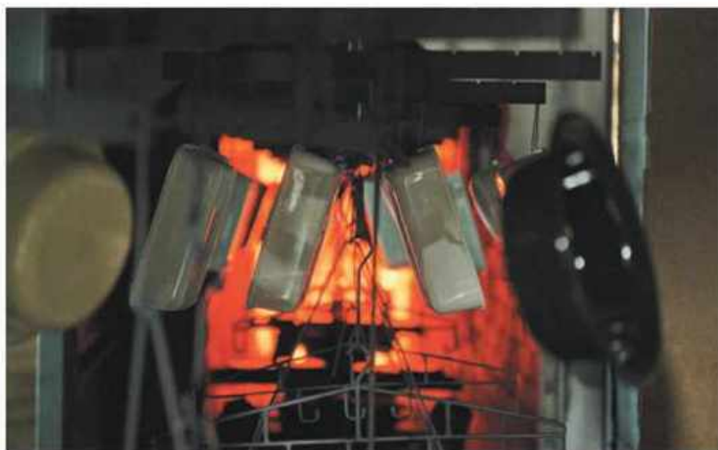
釉薬を乾かし、口ゴを押しした製品を焼成炉（約850℃）へ。高温の窯で、釉薬のガラス質をしっかりと定着させる。
