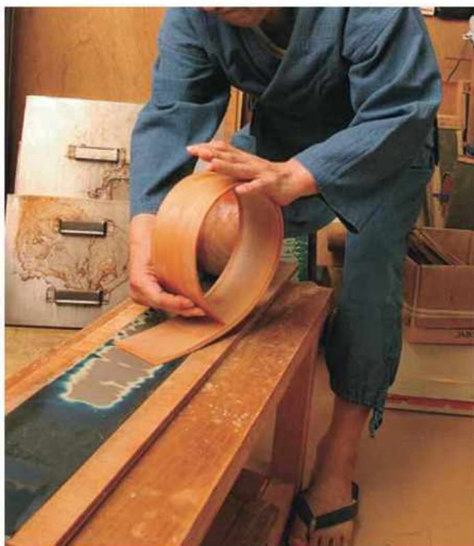
水分を吸わせた薄板を、湯気が立つうちにコロ（丸太）にのせて巻いていく。二枚重ねの曲げ加工は力が必要だ。
