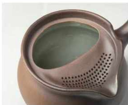
職人が手で開けた100個ほどの茶こし穴。ガラス釉をかけた内側なども「香ばしポット」「急須角」共に同じ仕様。
