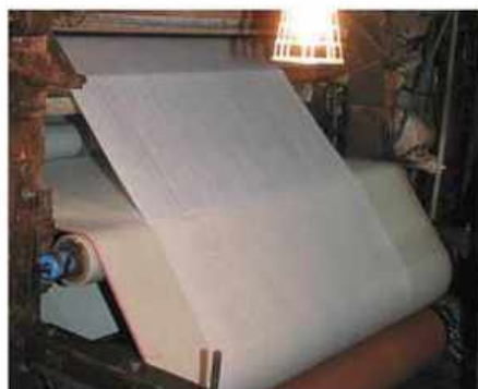
ローラーで圧力をかけて脱水し、乾燥させる。布と違い、紙は縫製にも技術を要する。美しい縫い目もまた魅力だ。
