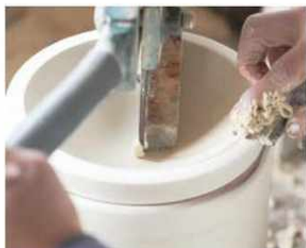
水ゴテ機械口口で、陶土を皿の形に成形する。
