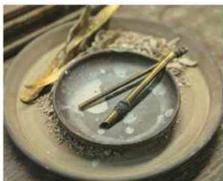
茶こし穴を開けるために使う道具「ボンス」。中は空洞になっている。新潟県燕三条で作られた真鍮製。
