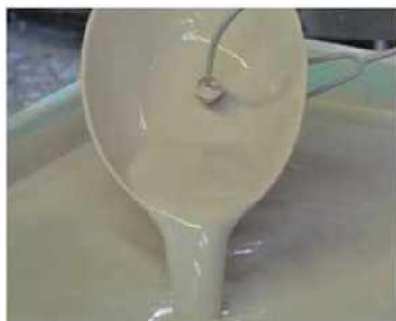
釉薬は独自開発の20種をそろえるが、土の膨張や割れを防ぐために、ベタライトを加え、工夫を凝らしている。
