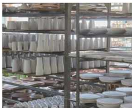
焼成を待つタンブラーやグラスなどの商品。この後、1300℃の高温で約13時間かけてしっかりと焼き締められる。
