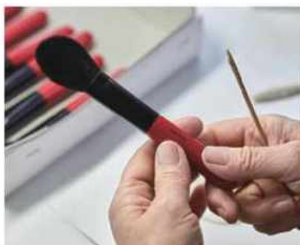
金具で縛められた筆先を軸に取り付けいたら、余分な毛が残らないよう浮毛取りをかけ、1本のブラシがで上がる。
