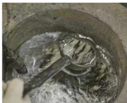
金属に熱を加え、溶かす工程。液体状になった金属を型に流し込み、形を作っていく。
