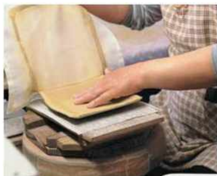
石膏の型の上に土を置き、布をかぶせて叩いて成型する「たたら」。この後、2〜3日自然乾燥させ、強度を与える。
