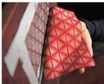
型紙を外した鹿革に美しく繊細な文様が表れる。この後、裁断・縫製まで職人が手作業で仕上げていく。
