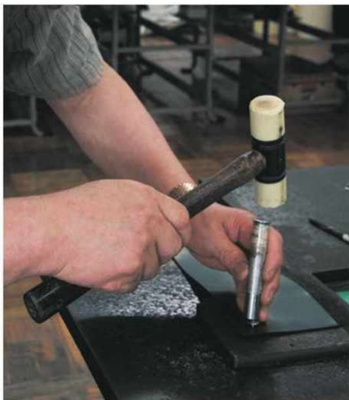
ポンチで穴を開け、カシメを留める工程。製品を傷つけないように「ツチ」と呼ばれるプラスチックハンマーを使う。
