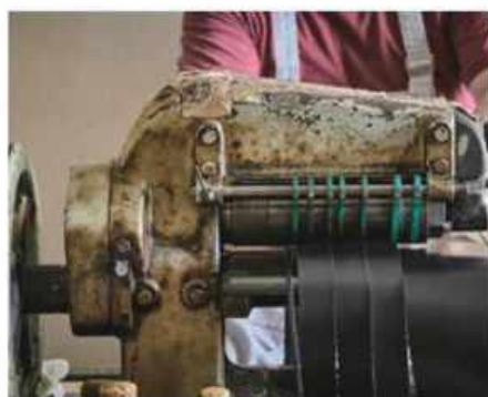
選り抜いた革を裁断するスリッター（裁断機）。約40年前の機械だが、今もなお現役で使われている。
