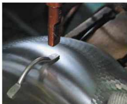
焦がすことがなく、また部品も不要なスポット溶接でつまみや取っ手を取り付ける。
