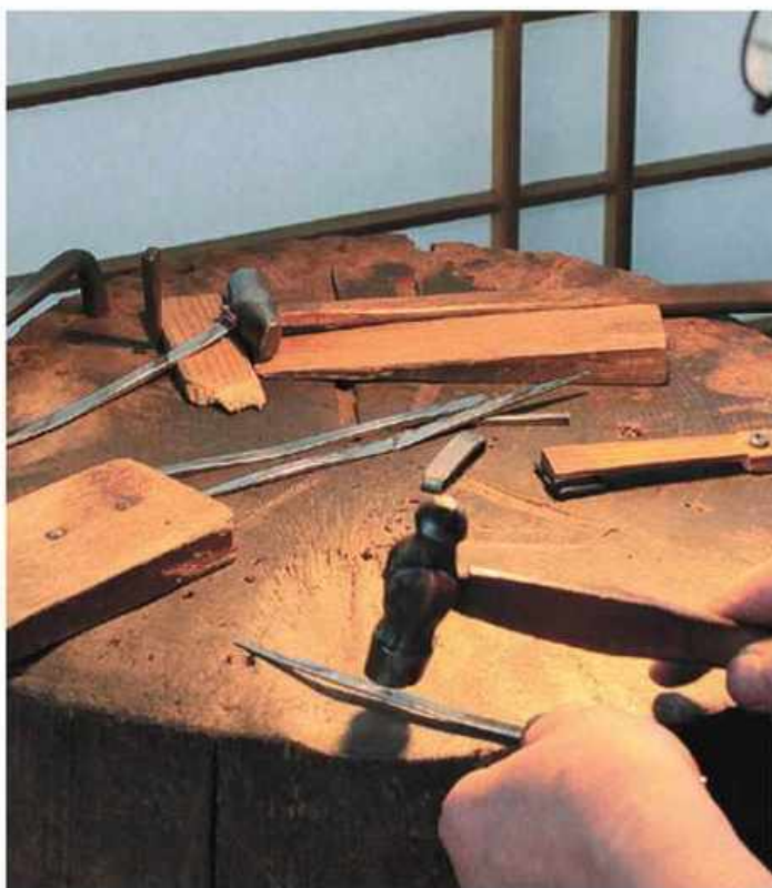
厚の台の上で毛を挟む部分に刃付けをし、先端を毛抜きに形に曲げる。弾力を確認しながら仕上げていく。
