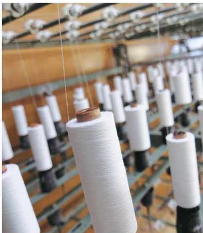
綿糸の「整経」の準備。綿糸を大きなドラムに巻きつけていく。柄ものはこの段階で模様となる色糸を入れる。
