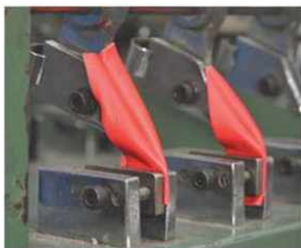
革にクリームを塗って、機械で引っ張り、そのつき具合を確認する「屈曲試験」。
