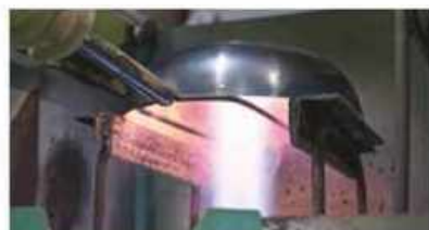
700℃近くで焼き込む「ハードテンパー加工」。焼きムラが一つずつ異なるのは、手作業で加工を施しているため。
