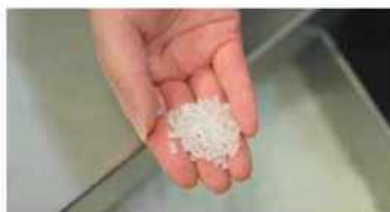
小さな粒状に加工された樹脂を機械へ入れ高温で溶かしてゆく。
