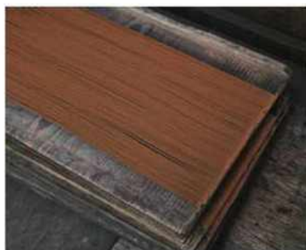
竹べらで隙間なく並べられ、過度の長さに成形する“盆切り”の作業を行なう。
