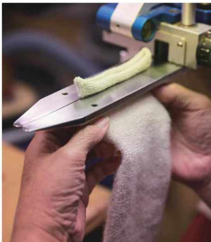
編み機で編みあげられた靴下はまた筒状だ。その後、たくさんの「人の手作業」によってカットや縫製などの工程が施され、段々と靴下の形になっていく。
