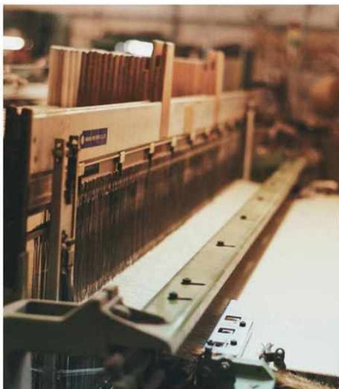
蒸系したささ和紙を機械に装着し、製品を巻き上げていく。伸縮性がないため、横糸を入れるのが難しい。
