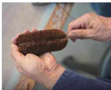
仕上げ作業。真ん中に棕櫚縄が入るよう慎重に巻き付ける。
