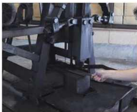
焼いた鉄をハンマーで叩いて伸ばし仕上げる昔ながらの製法も行っている。
