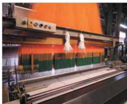
コンピュータを導入した最新の織機。パイル状に織ったら、反物状のまま水にさらして乾燥させ、裁断する。
