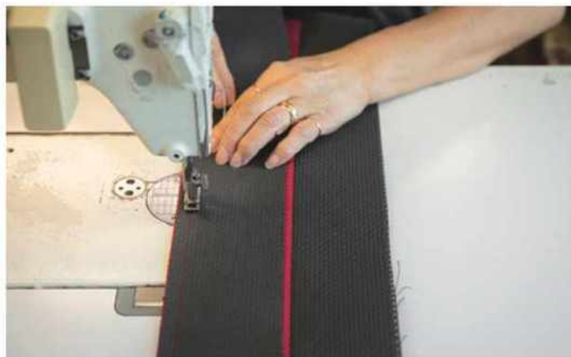
商品はすべて本社に併設された自社工場で作る。まち針1本刺さず、刺し子織の紋線に合わせて縫うのは熟練の技。
