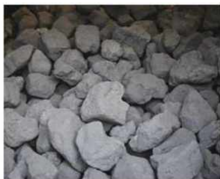
昔ながらのキューボラ作業の際には、鉄を溶かす燃料のコークスもまた欠かせない。
