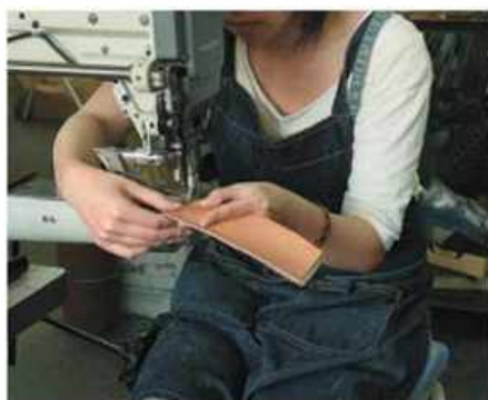
革専用のミシンで縫製する。財布のように小銭入れやカード入れがあるものは、部品も多い分工程も増える。
