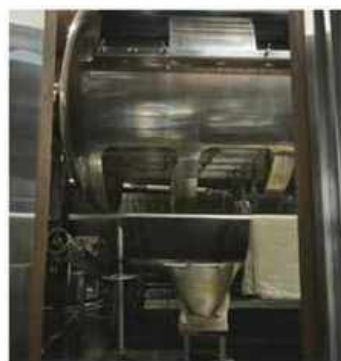
特注のドラム型磨機。ボタンひとつで回転し、大豆に麹菌を均等に付着させることができる。
