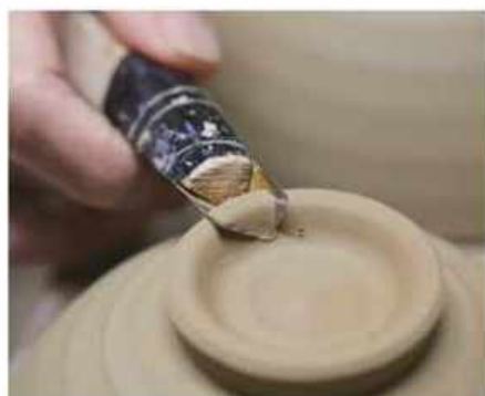
萩焼の特徴「切り高台」の工程。『萩陶苑』は自社で生地作りから焼成まで一貫して生産している窯元だ。
