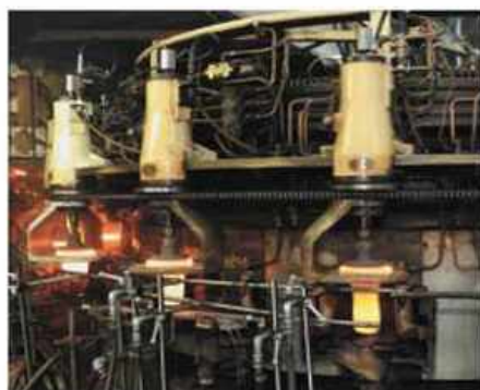
耐熱ガラスの原材料は100%天然の鉱物を精製したもの。泡を残さないための泡切り剤には塩を使用している。
