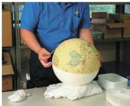
地図の手貼作業。のりしろの部分は白球の大きさにより異なるが、1枚が1mmずつ狂うと最終的には2cm近いズレに。
