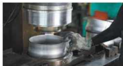
プレス機で絞りを施し成型。取手などは、溶接で一つひとつ丁寧に取り付けられる。
