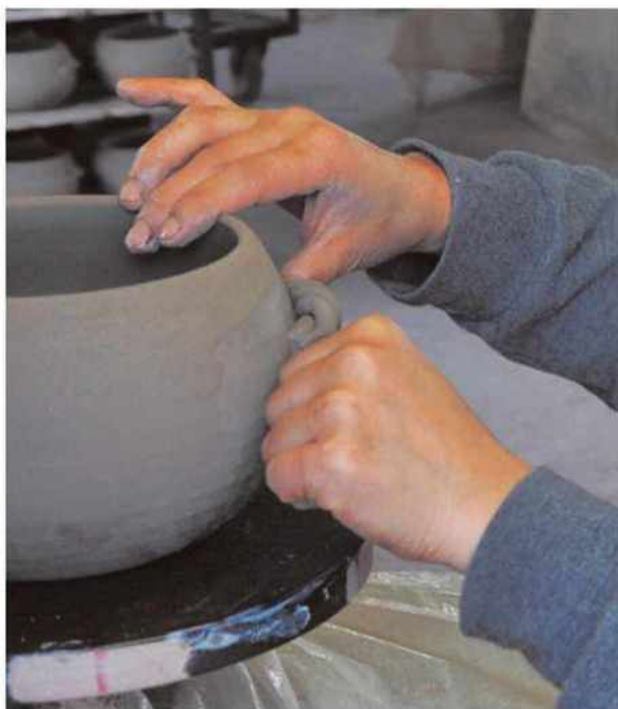
何の印もつけず、手でひねりを加えながら、持ち手を左右対称、同じ位置に付けていく工程はまさに経験の賜物。
