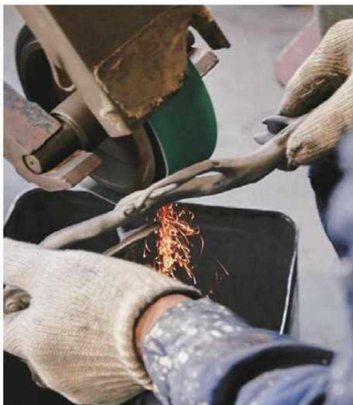
仕上げ作業。湯道（金属の流れる道）やバリ（金属を流した際に型の隙間にできる不要な突起）を落としていく。
