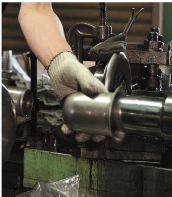
製品はスピニング加工で成形され、研磨のスペシャリスト集団によって磨き上げられる。
