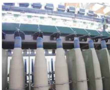
線糸を巻る際に使われる、リング巻糸機。
