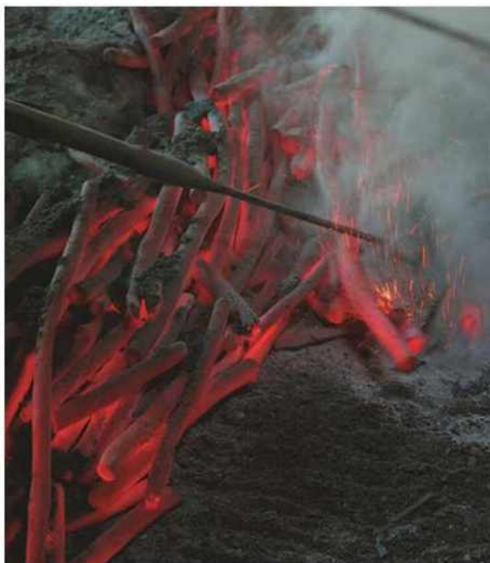
窯からかきだされた炭は、火がついているうちに水分を含んだ灰土をかけて冷やす。
