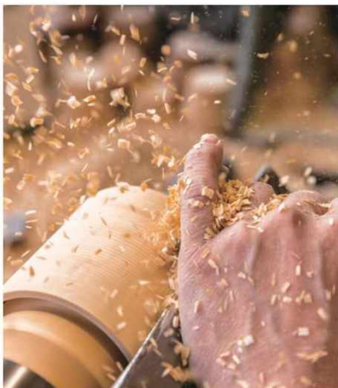
外側を整えるろくろ挽き作業。木くずを散らして瞬く間に削られていく。
