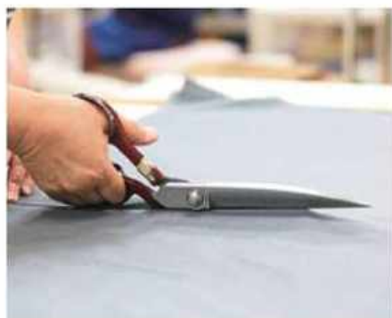
裁断機は使わず、職人が布の性質を見極めながら、裁ちばさみで1枚ずつ丁寧に布を切っていく。
