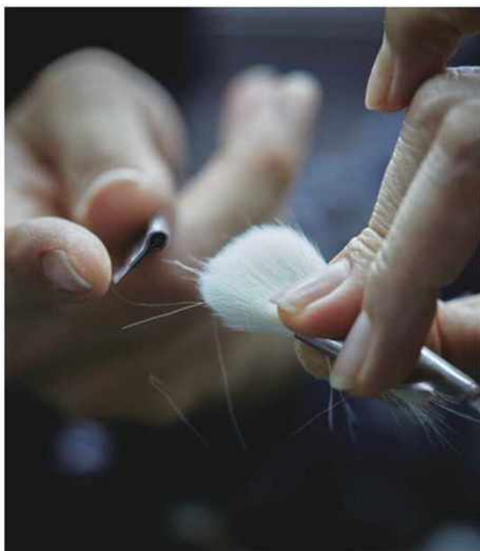
曲がったりした粗悪な毛を丁寧に取り除く。この繰り返しによりブラシの「形状」と「密集度」の精度を高めていく。
