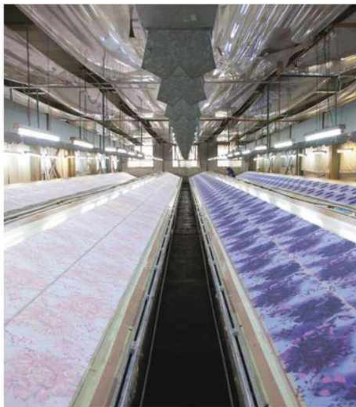
この工場では3台の半自動の捺染機のほか、手作業の捺染も行われている。
