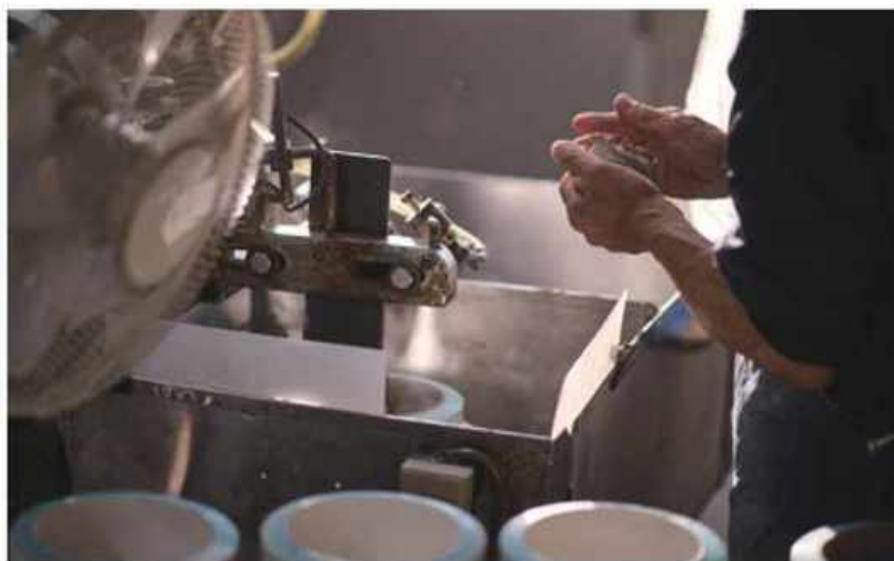
同じ土でも気温や季節などによって風合いの変化が生じることがある。複数の土を独自に調合することで、安定化させている。
