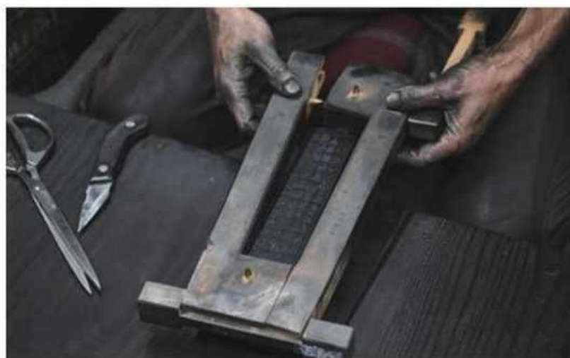
柔らかい状態の墨を木型で型取ってゆく。数分加圧した後、型から取り出すと、木型に彫られている繊細で美しい図柄が見事に転写されている。
