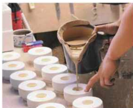
液状の土を石膏型に流し込む「鋳込み成型」。 石膏が水分を吸って土が収縮し、型から抜きやすくなる。
