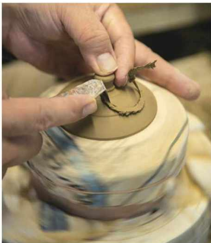
石膏型で形をとり、素焼き前に1つつ手作業で蓋のつまみを成型。本焼成では約1250℃でしっかり焼き締める。
