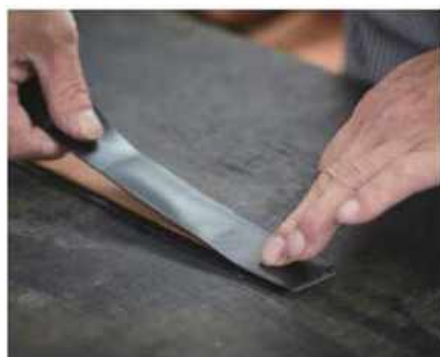
糊付けした革同士を貼り合わせる。少しのズレやシワも許されないため、注意しながら貼っていく。
