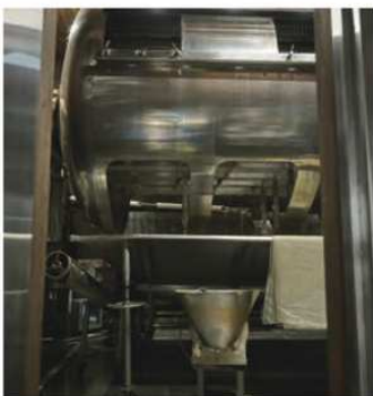
特注のドラム型麹機。ボタンひとつで回転し、大豆に麹菌を均等に付着させることができる。
