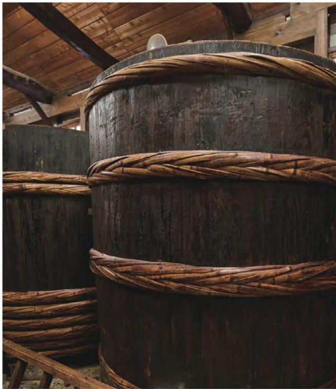
漆塗りで艶やかに仕上げられた木桶でじっくり発酵・熟成。 長年棲みついた微生物がもろみを育てる。
