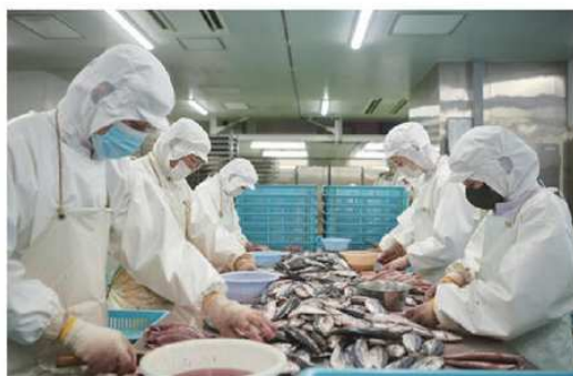
清潔な加工場。鰯は前日に丸のまま 20% の塩水に漬けて、マイナス 3 ～ 5℃ で冷凍。翌朝、半冷凍状態で捌く。
