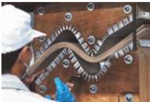
↑自社で設計、製作したプレス用の型を使って成形合板ならではの美しい曲線に仕上げていく。
