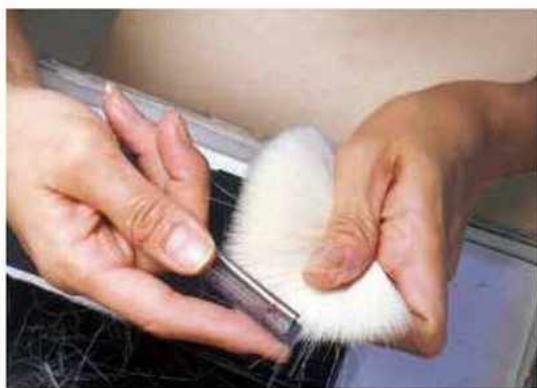
太い毛や逆毛などの粗悪な毛を取り除き、「揃え」と「成形」を並行して繰り返すことで、毛質の均一性の精度を高めています。
