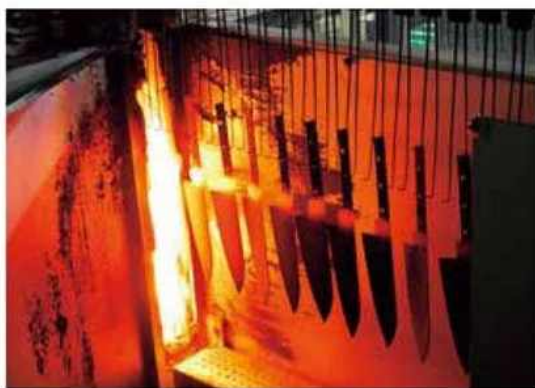
刀身を硬くするために、電気炉の中で1,050℃以上の高温に熱します。
