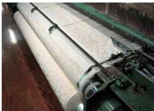
目で追えないほどの速度で機械に送られる糸。2種類の別々の糸を機械で巻きとって、1枚の大きなタオル生地に織り上げていきます。
