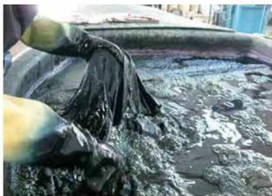
藍に浸しては引き上げて、酸化させる工程を繰り返し行い、より深い藍色へと染め上げていきます。
