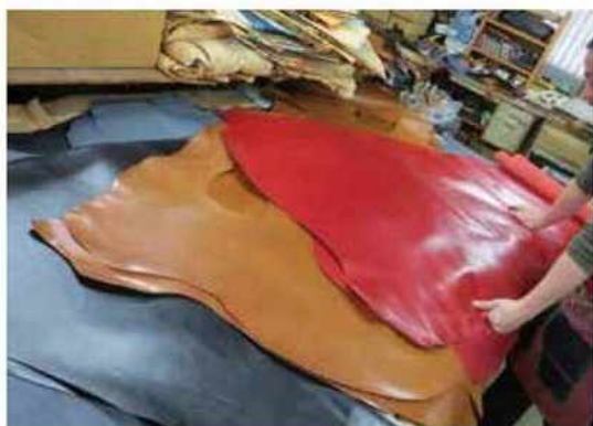
革の検品でキズや汚れのある部位をチェックし、裁断の際に製品に入らないよう外して裁っていきます。
