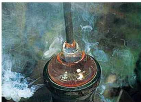
乳白硝子を作り出すあぶり出し技法は、明治・大正時代に盛んに使われた技法のひとつです。
