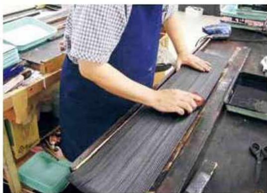
ベルトの側面(コバ)を仕上げています。「革工房いんのしま」ならではの丁寧な仕上げです。
