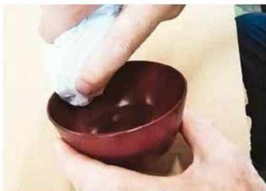
す 351 摺り漆仕上げは、木地に漆を摺りこませることで耐久性を上げ、漆独特の変化を感じていただけます。
