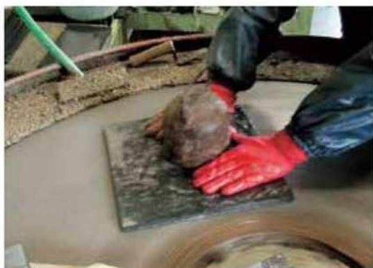
細かく切った石を平らになるように磨く作業です。一つ一つ丁寧に磨いています。
