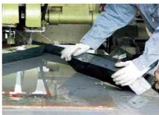
宮城県石巻市雄勝町で産出される雄勝玄昌石を採掘し、大きさや形に合わせて切断していきます。
