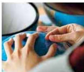
半球の球体を職人が1つ1つ丁寧に接合して、球体に仕上げています。
