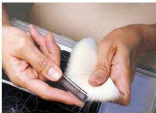
太い毛や逆毛などの粗悪な毛を取り除き、「揃え」と「成形」を並行して繰り返すことで、毛質の均一性の精度を高めていきます。
