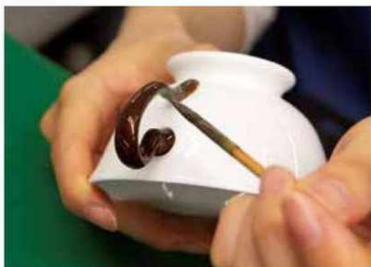
カップやソーサーのハンドルや縁には、筆で一点一点金が手塗りされ、白磁に美しい輝きを添えています。
