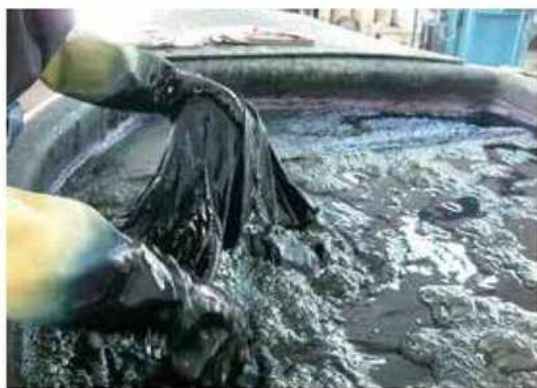
藍に浸しては引き上げて、酸化させる工程を繰り返して、より深い藍色へと染め上げていきます。
