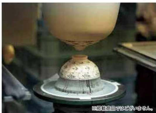
インクをつけたパットでひとつひとつ模様をつけていきます。
