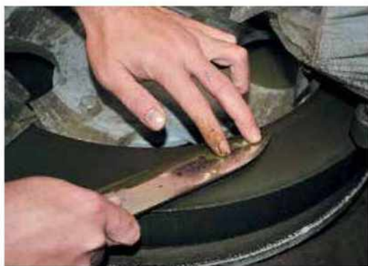
包丁を作るうえで、最も重要とされる刃付けの工程。熟練した職人によって一本ずつ命が吹き込まれていきます。
