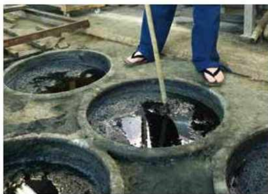
「薬」と呼ばれる藍を発酵させ、藍を建てています。泡のように見えるのは藍の華といい、良い状態の藍にできるものです。
