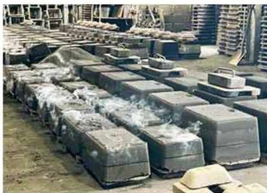
砂型に鉄を流し込み冷えて固まるまで長い時間が必要になります。
