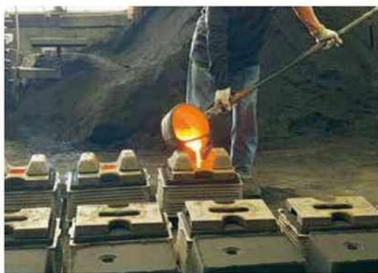
砂型に溶解した鉄を流し込む作業。鉄は非常に重たい材料のため、大変な作業のひとつとなります。
