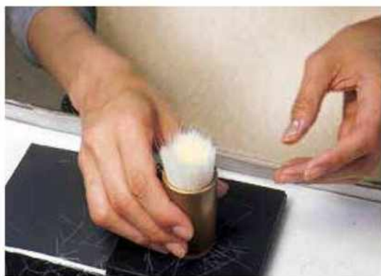
金属製のコマに天然の山羊毛の毛束を入れて振動を与えることで、毛先の「揃え」と「成形」を行います。
