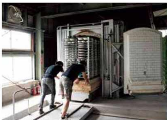
移動式の台車を備えたシャトル窯で焼成を行います。
