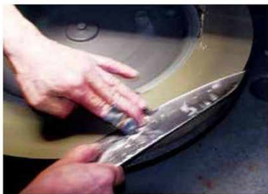
熟練の職人による丹念な手作業で仕上げられた刃部は、ダマスカス包丁特有の美しい波紋を有しています。
